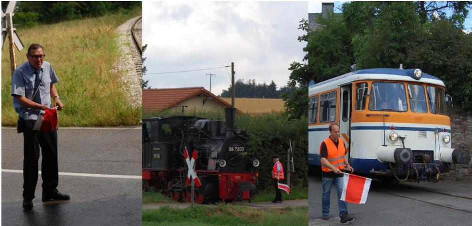
*Bild 8: Beispiele für Bahnübergangssicherung durch mitfahrende Posten*
