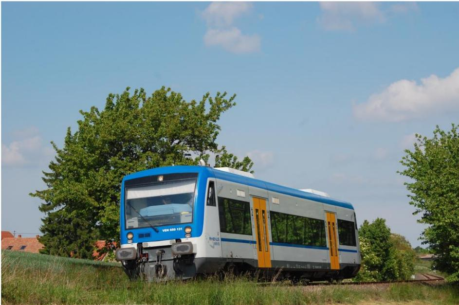
*Bild 21: SPNV mit modernem Triebwagen des Typs Regioshuttle*
