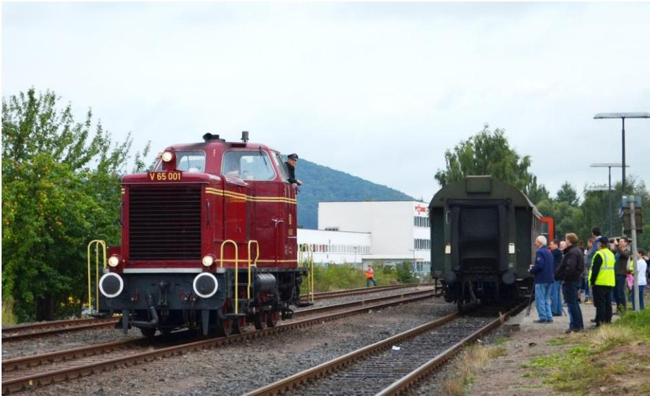
*Bild 20: Umfahren der Lokomotive um die Wagen am Endbahnhof*
